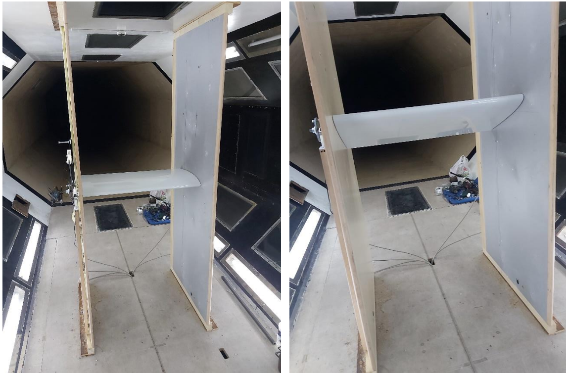
Слика 6.3.1 Аеропрофил НАСА 2415 постављен у испитну инсталацију у аеротунелу, пре монтирања дефлектора, који се уклањају при уградњи модела
