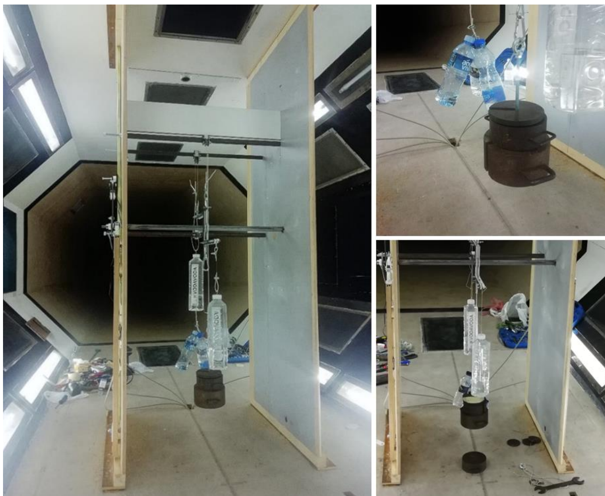
Слика 6.2.1 Калибрација мерног система комерцијалним металним теговима за узгон, као и наменски прављеним и калибрисаним теговима – флашицама са водом за отпор и момент пропињања
