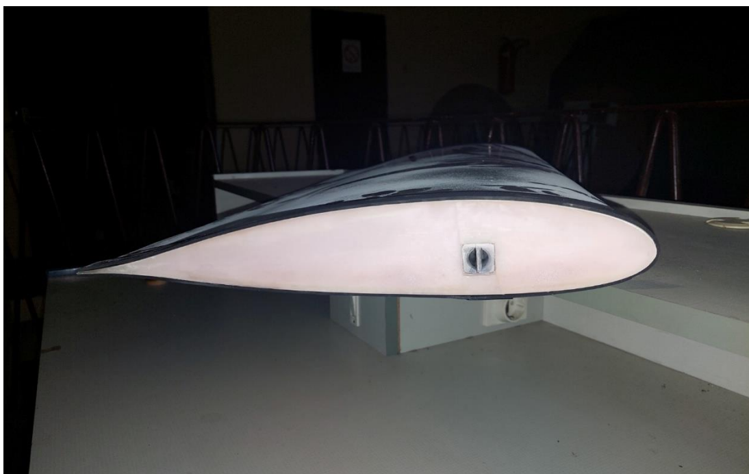
Слика 6.3.6 Аеропрофил NA - DEL 2415 са везном - обртном осом на 1/4 тетиве
