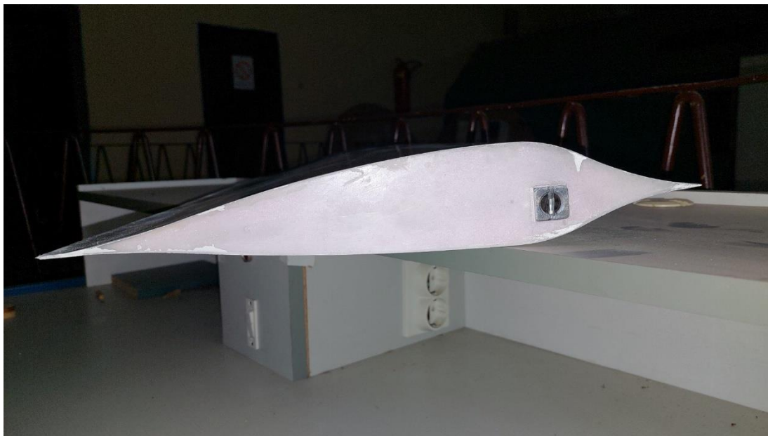
Слика 6.3.5 Оригинални аеропрофил Делфин 2415 са везном - обртном осом на 1/4 тетиве
