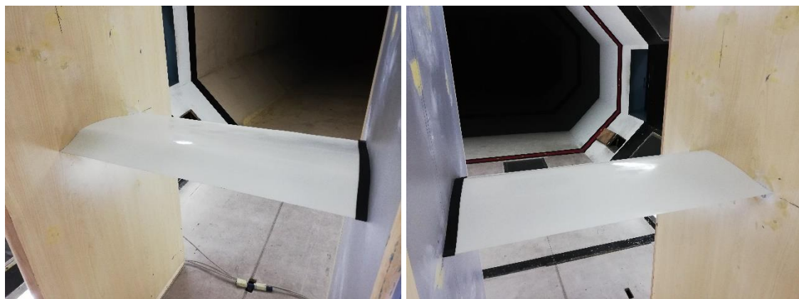
Слика 6.3.2 Аеропрофил Делфин 2415 постављен у испитну инсталацију у аеротунелу са нападном ивицом приказаном на слици лево и излазном ивицом на слици десно
