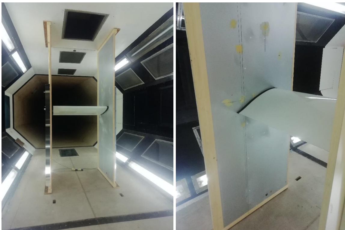
Слика 6.3.3 Аеропрофил NA - DEL 2415 постављен у испитну инсталацију у аеротунелу са приказом нападне (лево) и излазне ивице аеропрофила (десно)
