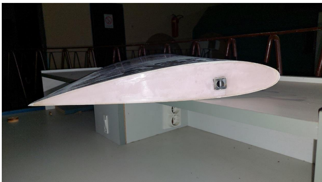
Слика 6.3.4 Аеропрофил NACA 2415 са везном - обртном осом на 1/4 тетиве
