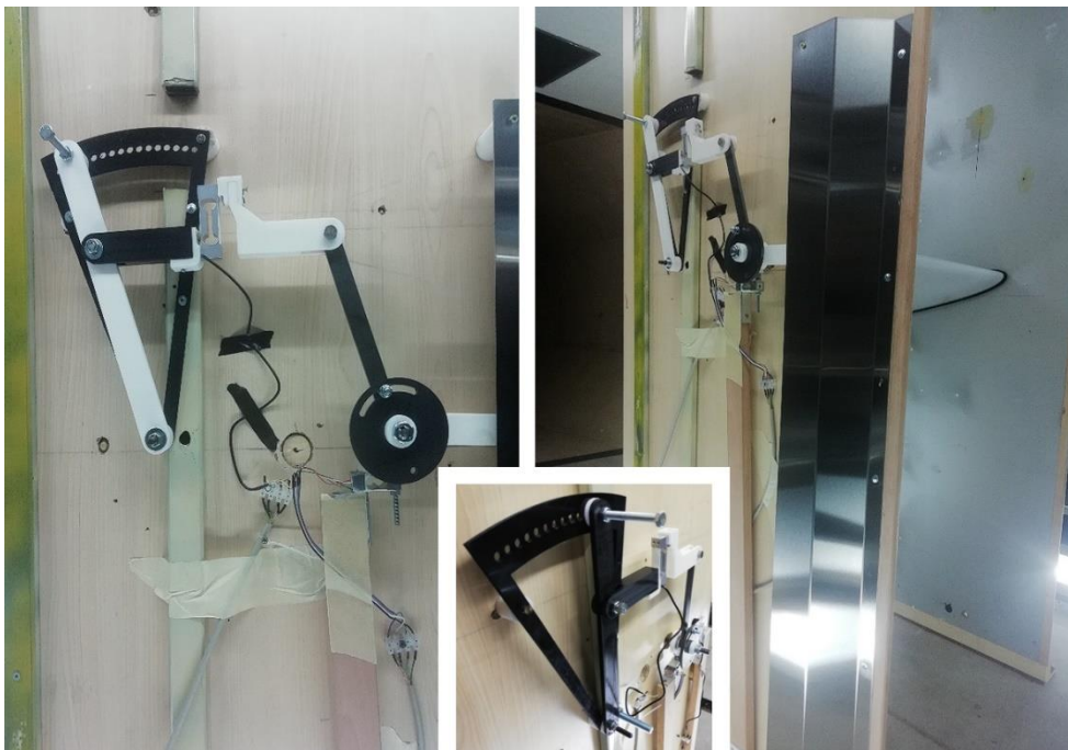
Слика 6.1.2 Механизам за промену нападног угла аеропрофила, сензори и дефлектор на левој граничној плочи
