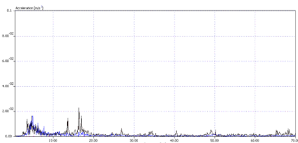
Сл. 4. Упоредни приказ сигнала убрзања у фреквентном домену улазног вратила редуктора радног точка багера SRs2000.28/3, за нову и стару варијанту
