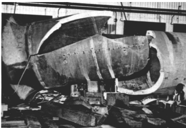
Slika 1. Havarija debelozidne posude pri probnom pritisku
