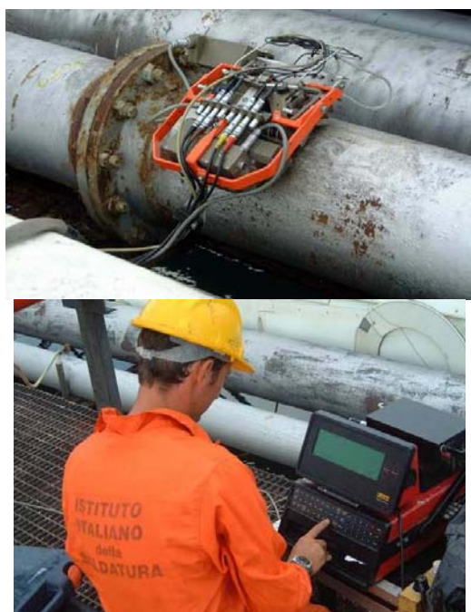
Slika 12. Sistem za ispitivanje T-SCAN tehnikom: skener na kolicima (gore) i sistem za akviziciju podataka (dole)
