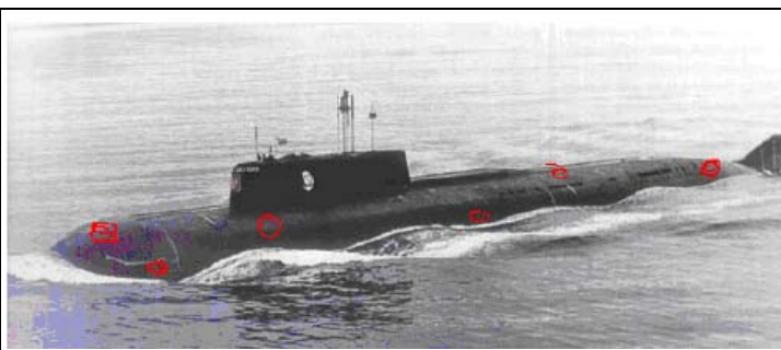
Slika 6. Korozija spoljnje površine podmornice /11/ Figure 6. Corrosion of submarine outer surface /11/
