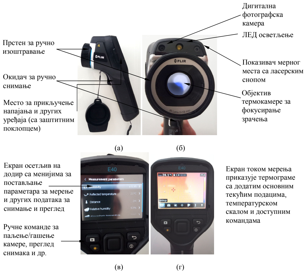
Слика 5. Термокамера FLIR E40 SC са означеним деловима (а) приказ са стране (б) приказ са предње и (в) са задње стране – екран при постављању података за мерење (г) екран при самокалибрацији
