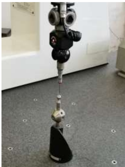
Slika 5 - Kalibracija sonde vršena na sfernom kalibracionom primitivu
