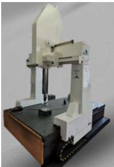
Slika 8 – Prikaz realne merne mašine - Physical twin
