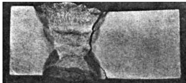
Slika 8 Mikroprslina u zoni uticaja toplote u zavarenim spojevima
