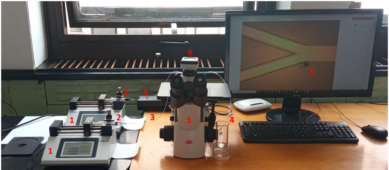
Slika 2. Postavka metode za posmatranje i analizu protoka fluida u Si-Pyrex staklo opto-mikrofluidnim platformama: 1-špric pumpa. 2-medicinski špric za 10 ml sa montiranim iglama prečnika 0.8 mm. 3-ulazna FEP creva prečnika 800 \mu\text{m} . 4-izlazno FEP crevo prečnika 800 \mu\text{m} . 5-metalografski mikroskop. 6-kamera. 7-fotografija (uživo snimak, video zapis) silicijumske Y račve.
