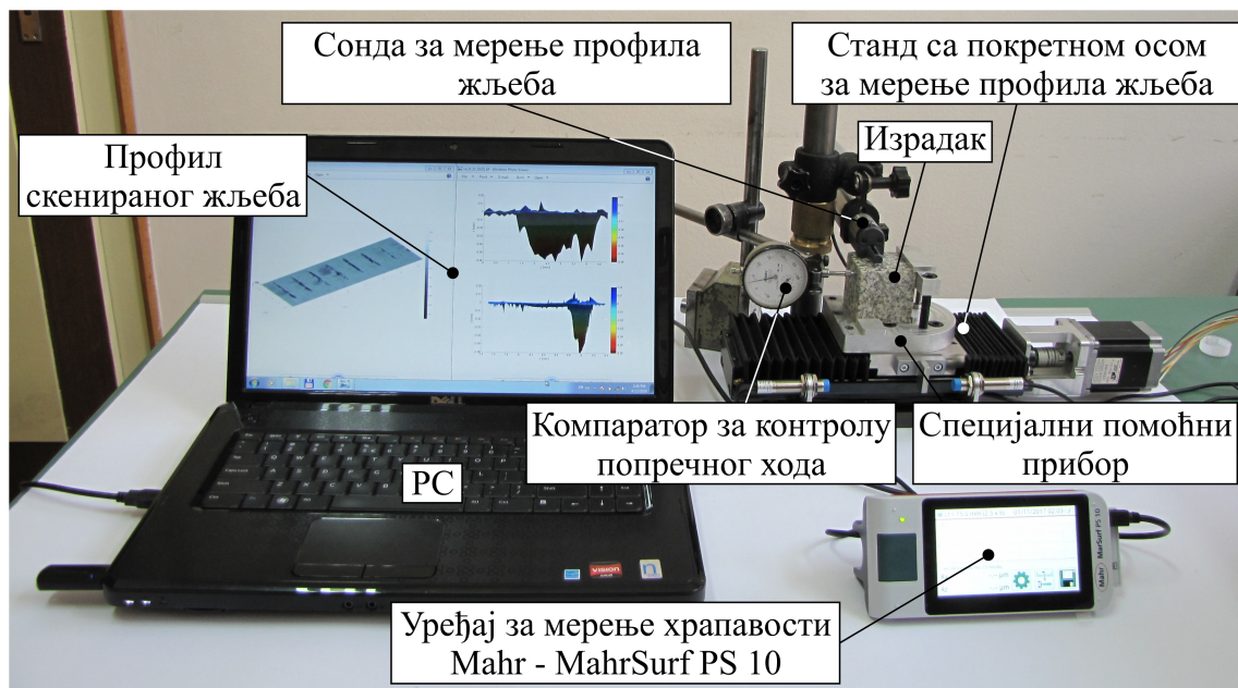
Слика 4.7: Експериментална поставка за мерење профила израђених жљебова микро резањем дијамантским алатом.
