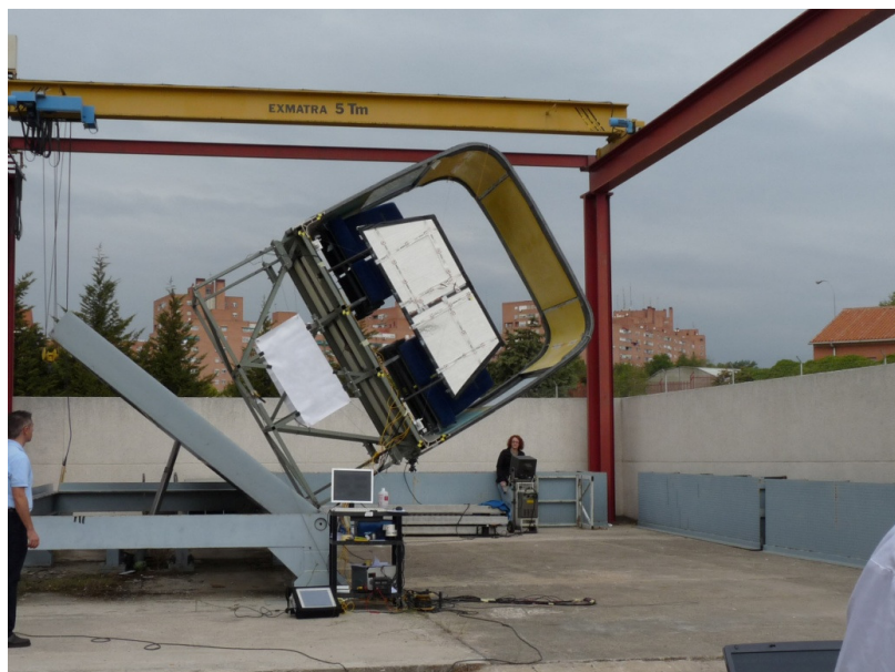
Slika 3.9. – Segment autobusa na nagibnoj platformi u procesu ispitivanja
