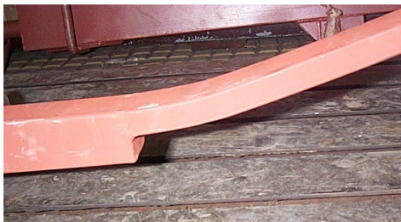
Slika 6.1. – Izgled tipičnog plastičnog zgloba u strukturi autobusa
