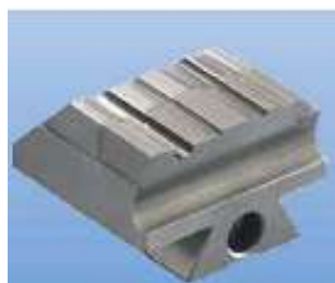
Slika 2 Prizmatični profilni strugarski nož izrađen od brzoreznog čelika
