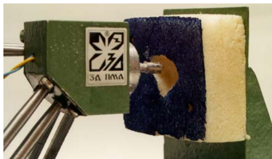
Slika 5. Obrada udubljenja u peni oblika radnog prostora za 3D PMA
