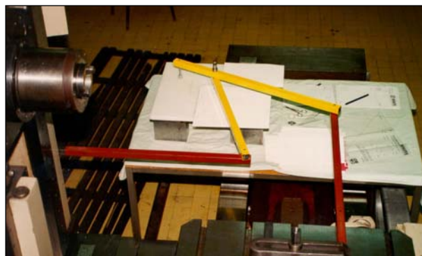
Slika 11. Prikaz eksperimentalne opreme sa 2D tehnološkim modulom montiranim na baznoj mašini HBG 80, u toku izvođenja eksperimenta
