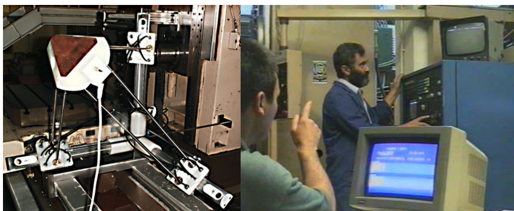
Slika 7. Simbioza HBG80 i simulatora mašine P3, koja koristi komunikaciju PC-Bosch za transfer programa u upravljačku jedinicu
