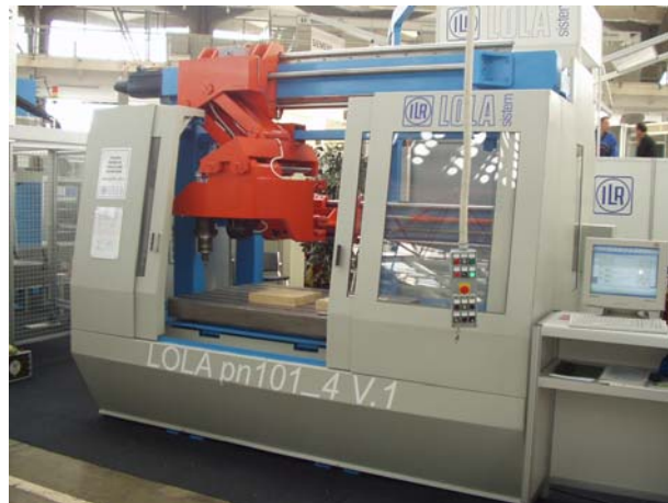
Slika 1. Prototip prve domaće troosne paralelne mašine sa mehanizmom pn_101
