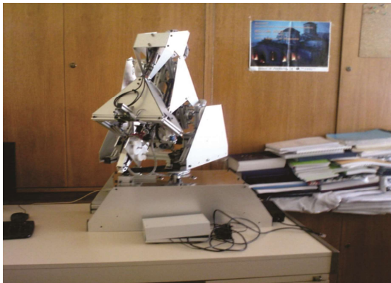
Слика 4.1а. Лабораторијски NeuroArm робот манипулатор са 7 степени слободе
