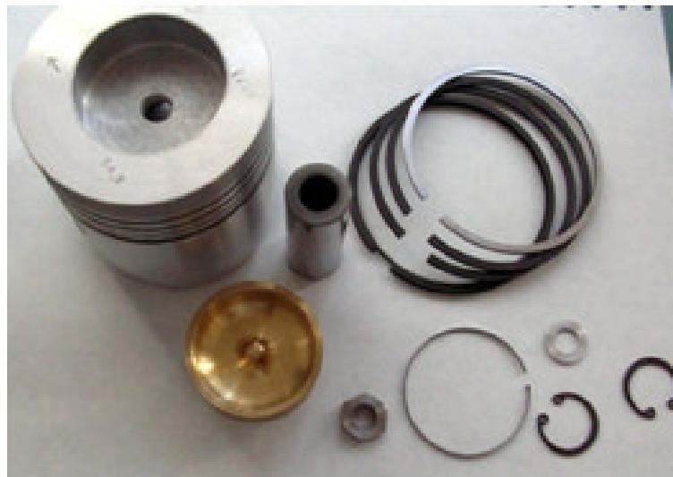
Сл.1- Елементи новог клипа са КДС комором од коване алуминијум-бронзе (Al-Br)
