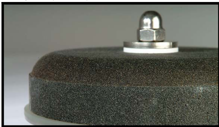
Slika 3. – Generator za proizvodnju ozona i porozni distributer-difuzor ozona na postrojenju
