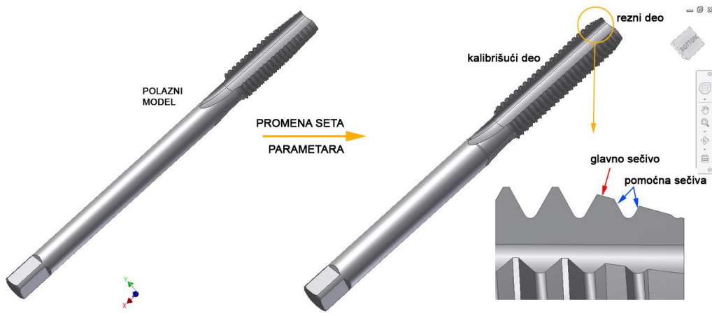
Slika 4. Parametarski definisan mašinski ureznik sa pravim žlebovima
