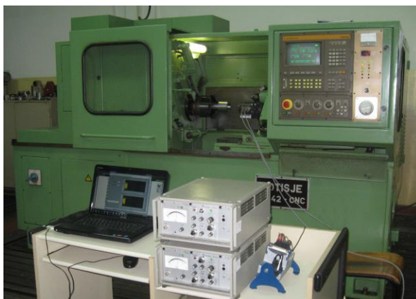
Slika 1. Prikaz obradnog i merno-akvizicionog sistema KNU struga
