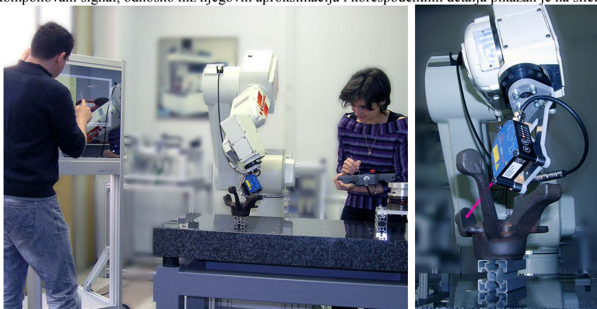
Slika 4: Demonstraciona instalacija razvijena za potrebe eksperimentalne verifikacije kritičnih istraživačkih sadržaja koncepta robotizovanog skeniranja objekata kompleksne prostorne geometrije primenom laserskih triangulacionih senzora.
