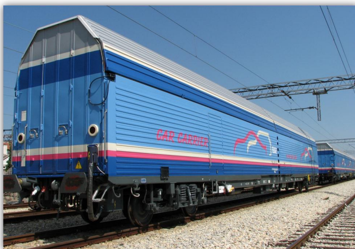
Slika 6. DDM vagon sa ugrađenim Završnim signalima ZS 01-LED
