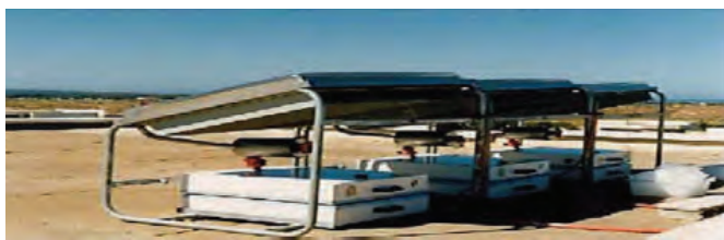
Slika 9: Solarni adsorpcioni uređaj za proizvodnju leda
