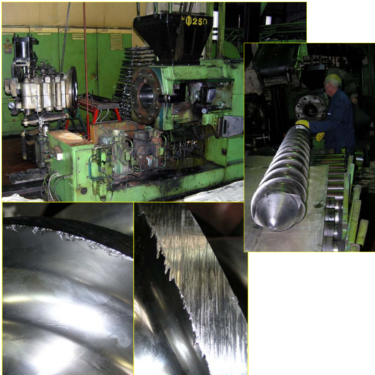
Slika 8: Detalji iz faze identifikacije stanja ekstrudera Francis Shaw D250. U pitanju je ekstruder ekstremno velikog kapaciteta, koji predstavlja jednu od ključnih mašina u okviru TRAYAL korporacije za segment tehnologije ekstruzije elastomera. Ekstremni režimi rada i naprezanja materijala doveli su do drastičnog degradiranja radne geometrije, što je za dalju posledicu imalo prekomerno povećanje radne temperature i značajnu degradaciju kvaliteta proizvoda.
