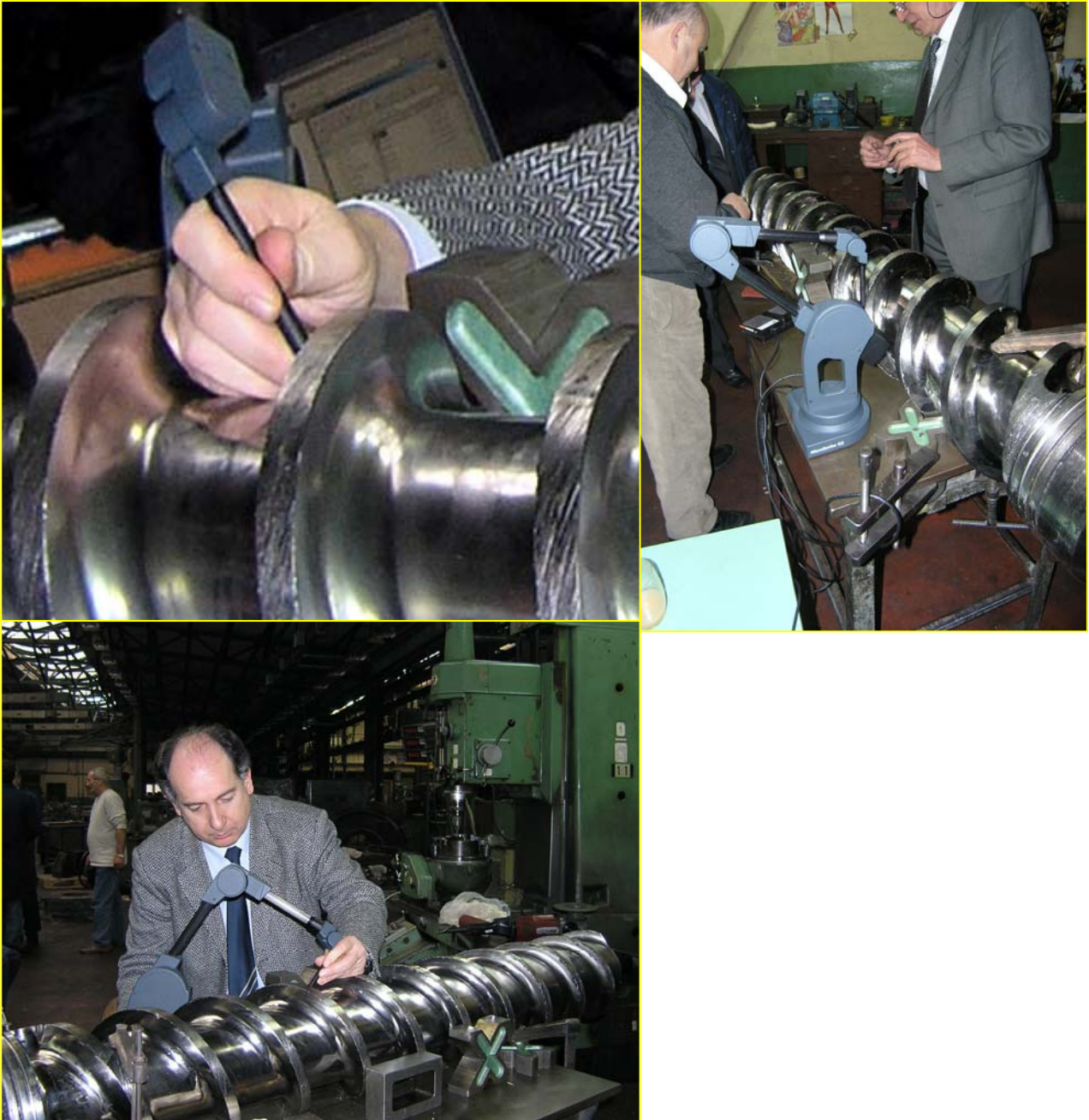
Slika 9: Detalji iz faze identifikacije geometrije pužnog vretena gde je razvijena i primenjena nova metoda bazirana na trodimenzionalnom skeniranju. Vreteno ekstremnih dimenzija, mase oko 1000 kg i kompleksne prostorne geometrije skenira se primenom digitalnog prostornog kontaktnog skenera sa tačnošću na nivou stotog dela milimetra uz odgovarajuću obradu merenih podataka specijalno razvijenim softverom sa statističkom geometrijskom kompenzacijom greške.
