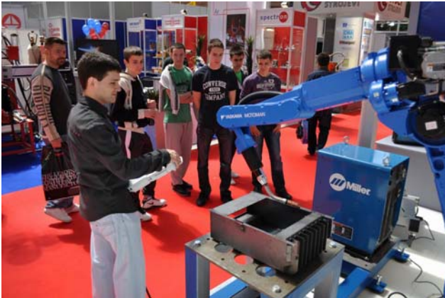
Slika 11: Virtuelni model robotske tehnološke ćelije za završnu montažu sklopa ložišta peći na pelet iz proizvodnog programa kompanije Milan Blagojević iz Smedereva. Virtuelni model je izrađen za potrebe preliminarnih analiza izvodljivosti robotizacije montaže ovog sklopa i praktično je demonstriran na Sajmu tehnike u Beogradu, maja meseca 2011. godine (na fotografiji se vide dva mlada istraživača na projektu TR35007, doktoranti Nikola Lukić i Ivan Danilov, koji su programirali robotski sistem, prenoseći virtuelni model robotske ćelije razvijen u CAD okruženju u fizički prostor upravljačkog sistema robota).
