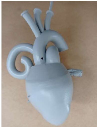
Slika 9. Sklop sa nanesenim prajmerom i špic-gitom metodom airbrush-a
