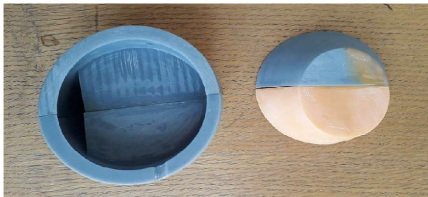
Slika 5. Delovi zalepljeni dvokomponentnim epoxy lepkom
