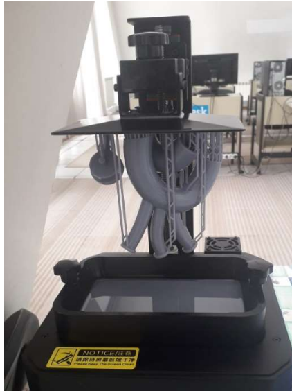
Slika 2. Odštampani delovi na platformi štampača
