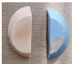
Slika 4. Fotopolimerom popunjene neravnine i rupe, očvršene i ošmirglane
