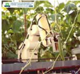
Slika 21. Autonomni modularni robot za brajne krastavaca u zatvorenom prostoru, [35, 36] Figure 21. Autonomous indoors modular robot, cucumbers harvest, [35, 36]
