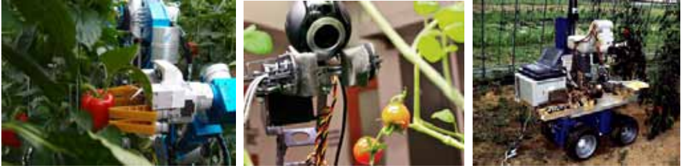
Slika 22. Autonomni robot za ubirajne paradajza i paprike u zatvorenom prostoru, [38] Figure 22. The Autonomous indoors robot, tomato and red peper harvest, [38]
