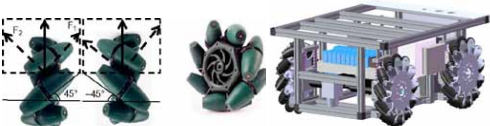
Slika 13. Dizajn točkova koji su pokretni u više pravaca (omni-direkcional sistem), [28, 42]. Figure 13. The omni-direkcional wheels, [28, 42].
