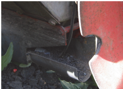
Sl. 3. Izgled senzora postavljenog u ulagač semena
