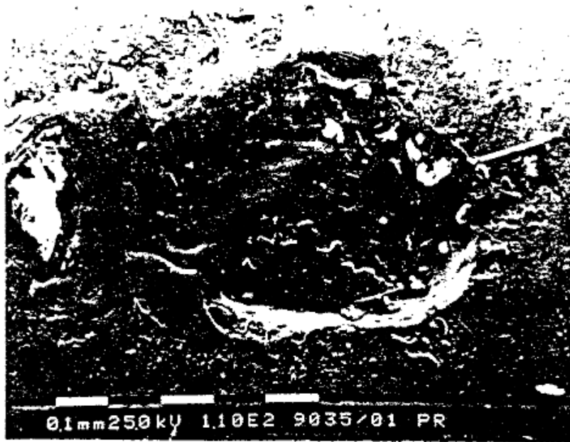
Sl.5.SEM mikrografija povrede laserom (mesto br.1 sa sl.1)
