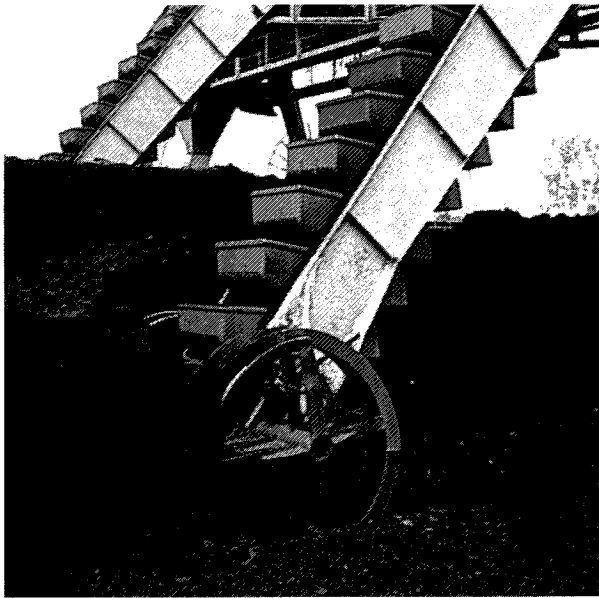
Слика 2. Кретање кофица у зони захватања угља Figure 2. Bucket movement within the coal reclaiming zone
