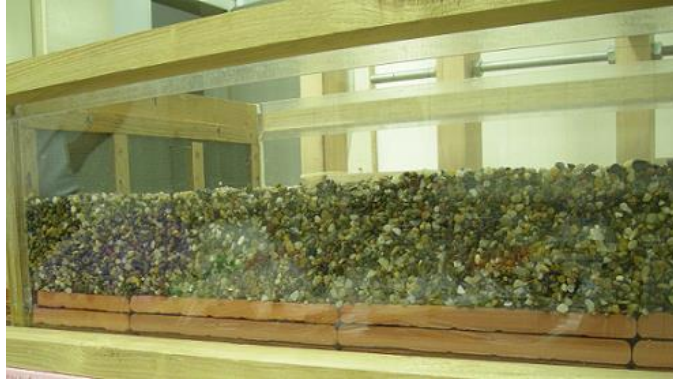
б) постављање првог слоја аквифера - слоја шљунка
