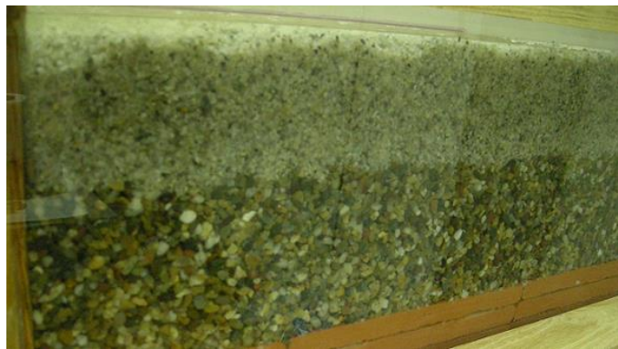
в) постављање другог слоја аквифера - слоја кварцног песка
