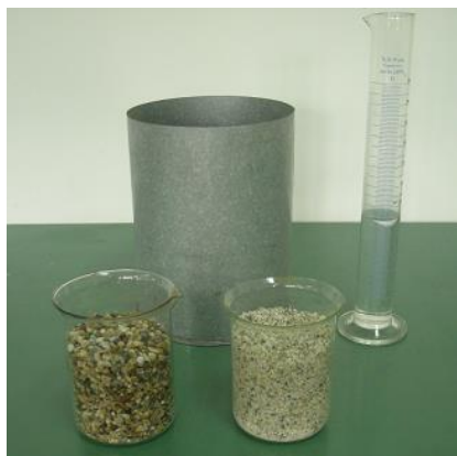
Слика 30. Одређивање порозности оба слоја аквифера
