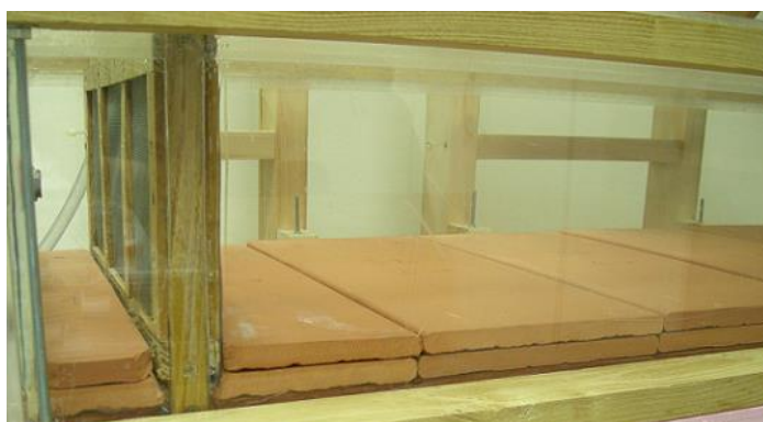
а) постављање доњег непрпусног слоја
