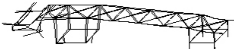
Osmi sopstveni oblik oscilovanja f_{08}=16.3 Hz
