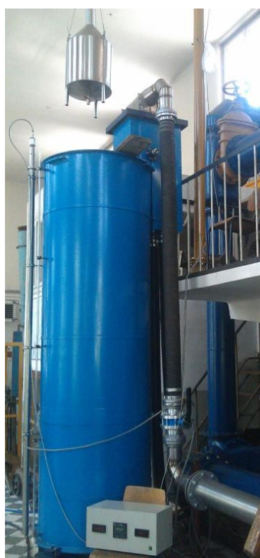
Слика 1. а) Изглед дела опитног постројења – волуметријски резервоар са дивертером на врху б) цртеж опитног постројења за еталонирање протокомера
