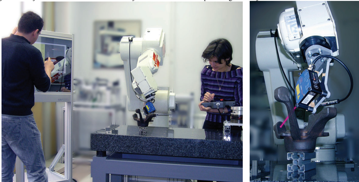
Slika 4: Demonstraciona instalacija razvijena za potrebe eksperimentalne verifikacije kritičnih istraživačkih sadržaja koncepta robotizovanog skeniranja objekata kompleksne prostorne geometrije primenom laserskih triangulacionih senzora.
