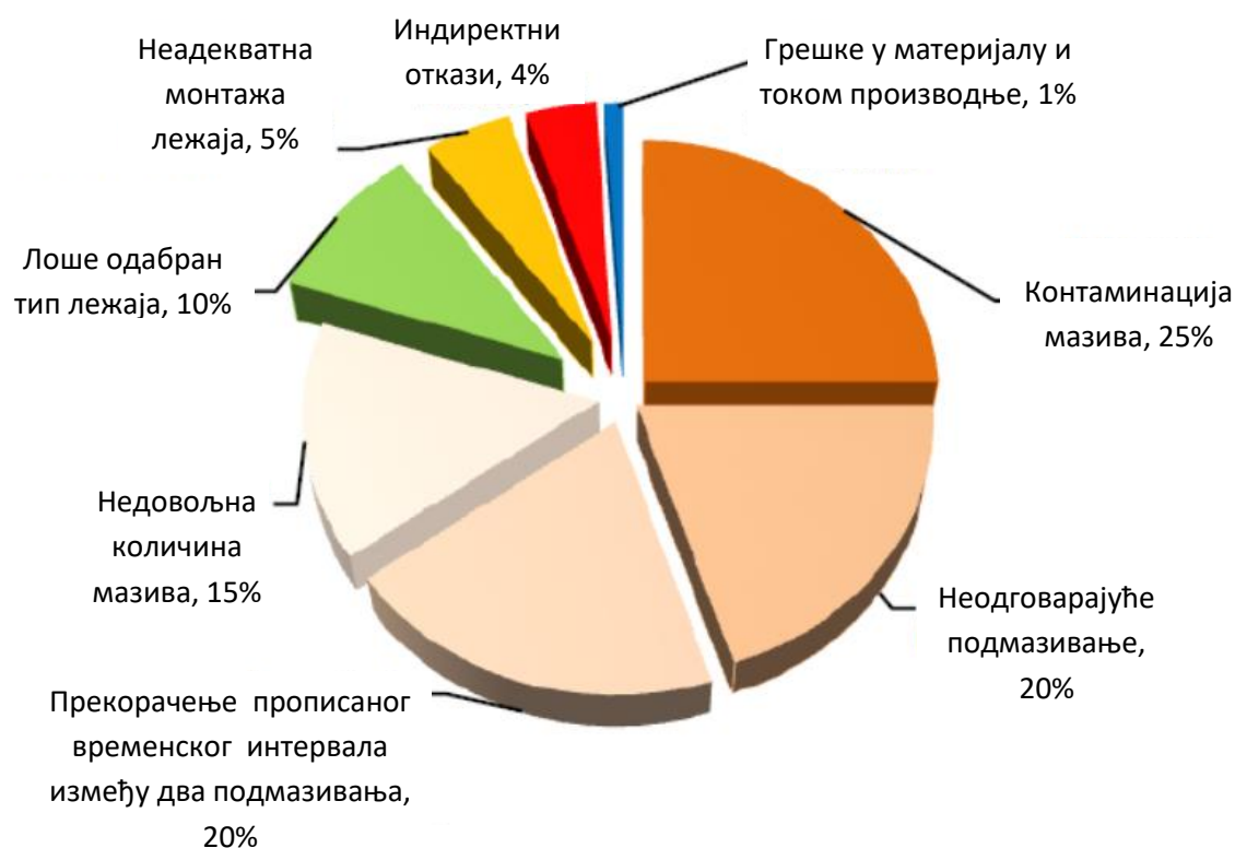
Слика 2.12: Најчешћи узроци отказа котрљајних лежаја – подаци компаније SKF
