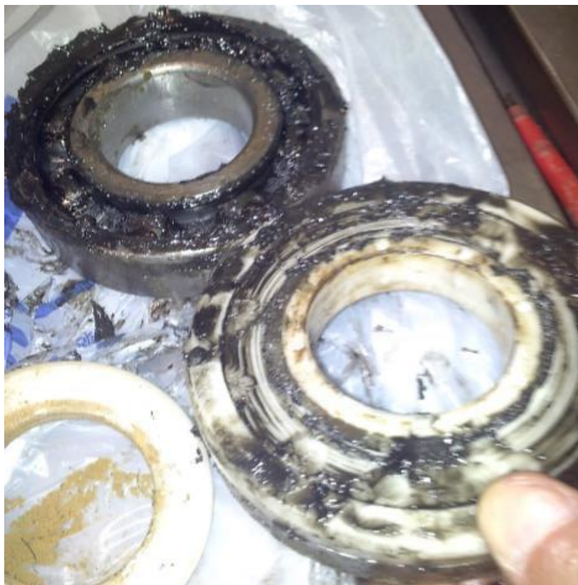
Слика 4.65: Расклапање отказалих котрљајних лежаја транспортних ваљака са површинског копа 'ДРМНО'
