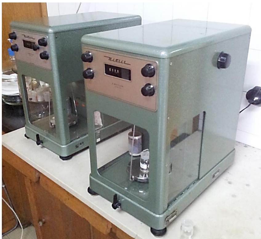
Слика 4.73: METLER прецизне ваге коришћење за одређивање масе мазива у испитаним лежајима
