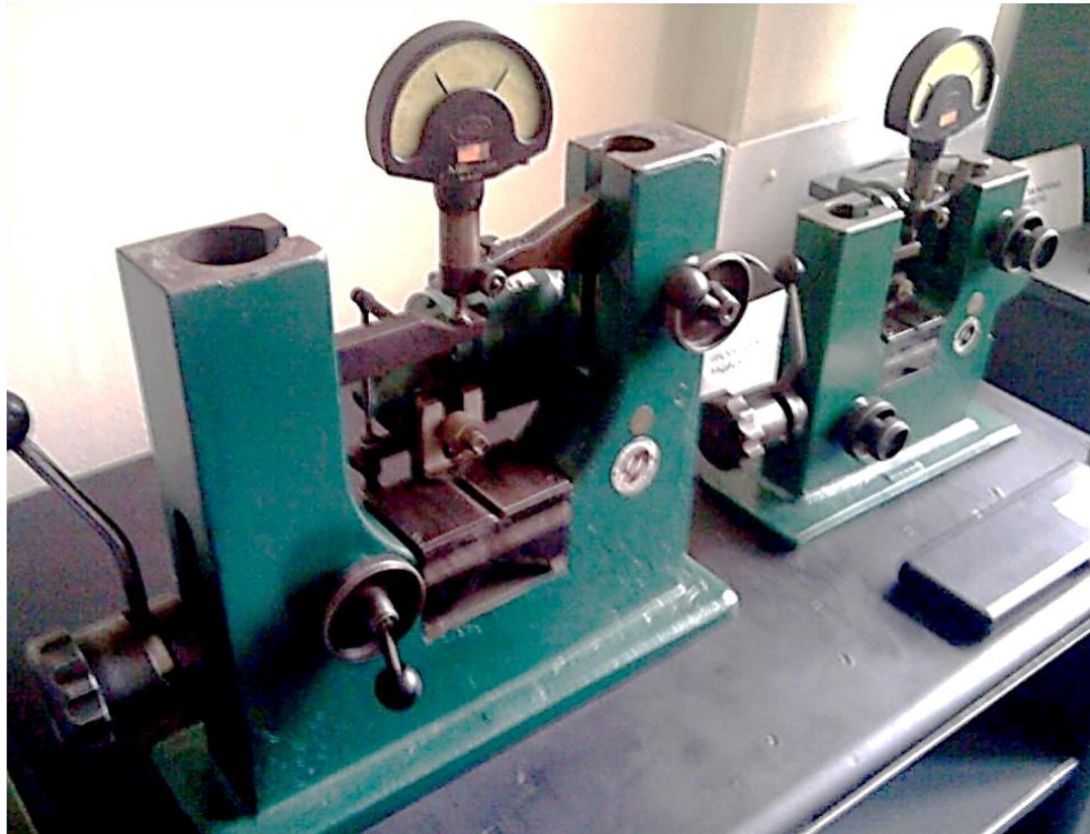
Слика 4.71: Уређаји за мерење радијалног зазора акредитоване лабораторије ЛИМЕС Машинског факултета Универзитета у Београду
