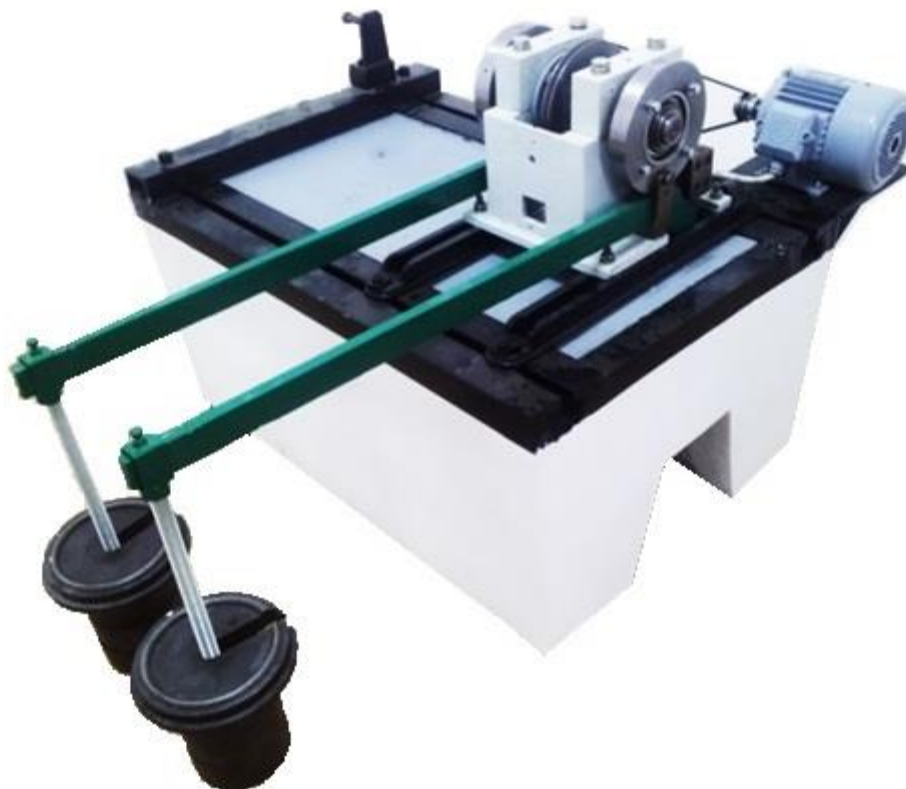
Слика 4.75: Принцип рада, тродимензионални приказ и општи изглед пробног стола за испитивање котрљајних лежаја, развијеног на МФБГ
