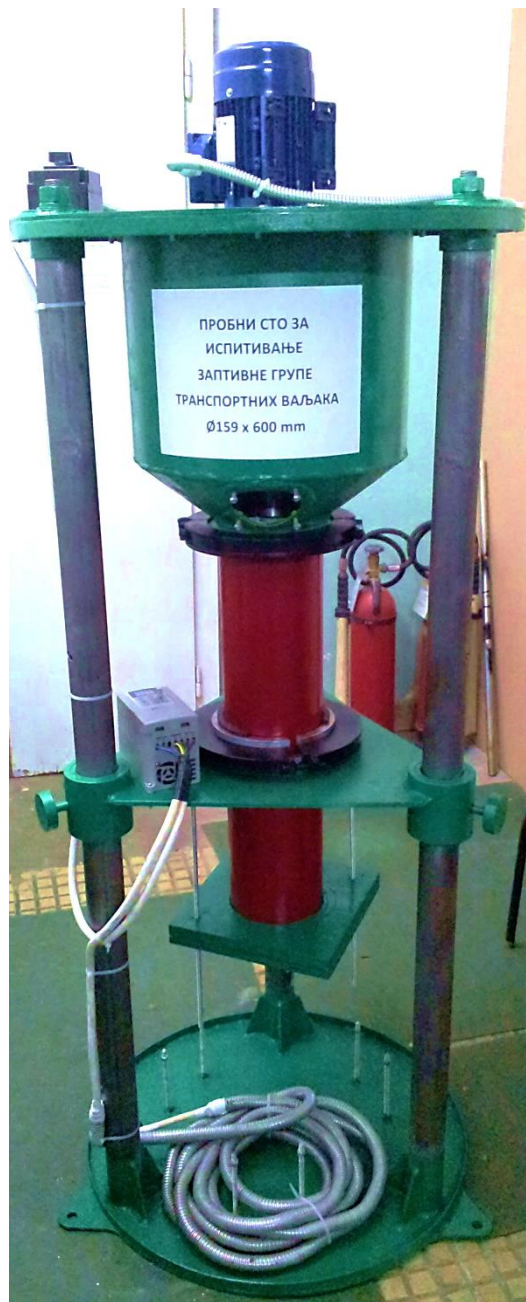
Слика 4.22: Пробни сто за испитивање заптивних група транспортних ваљака развијен на Машинском факултету Универзитета у Београду
