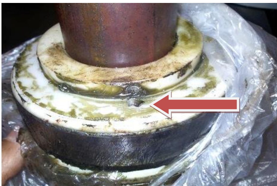
Слика 5.5: Струготина на задњем делу лежаја (унутар тела ваљка)
