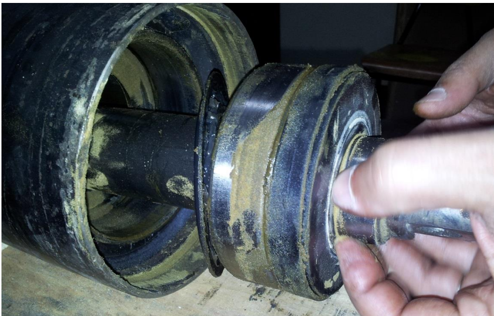
Слика 5.6: Нечистоће су прошле и у унутрашњост тела ваљка
