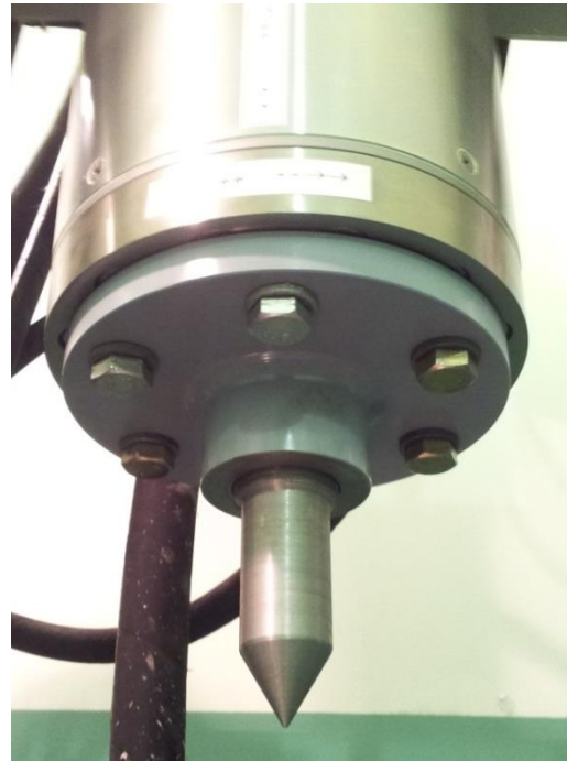
Слика 4.46: Монтажа алата за избијање осовине
