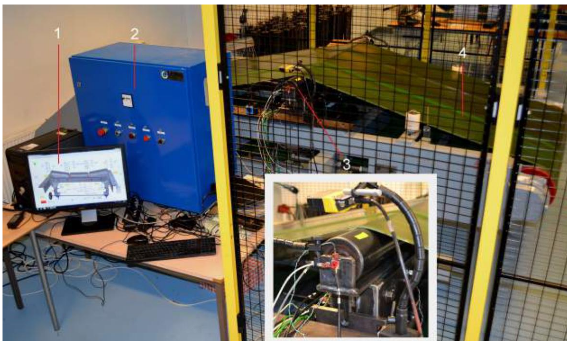
Слика 3.16: Пробни сто за испитивање транспортних ваљака развијен на Технолошком Универзитету у Делфту [46]
