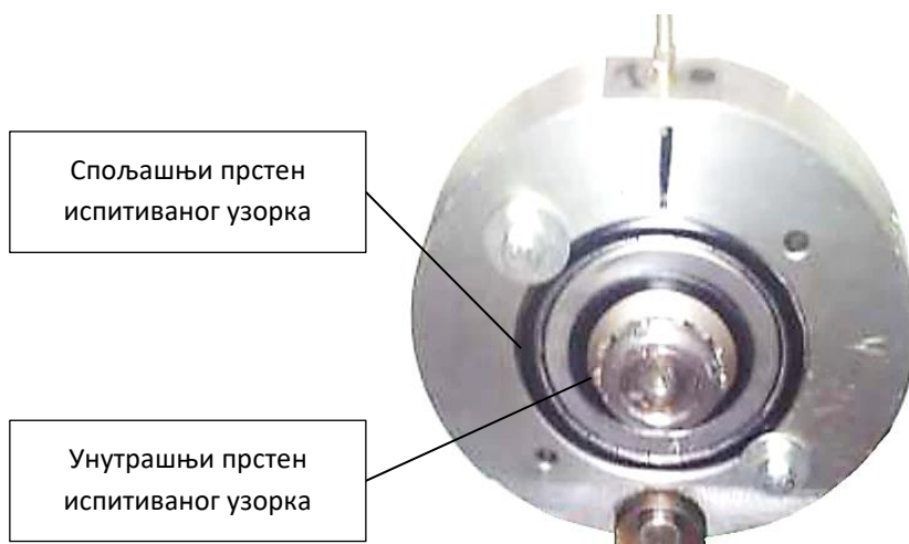
Слика 4.77: Припрема узорка за испитивање термокамером
