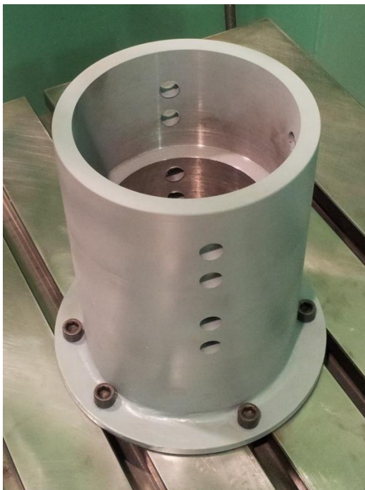
Слика 4.47: Монтажа алата за прихват испитиваног транспортног ваљка
