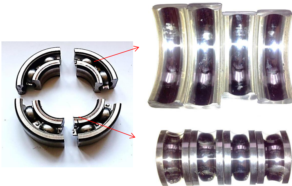
Слика 5.25: Узорци стаза котрљања са спољашњих и унутрашњих прстенова испитаних лежаја 6310-2Z/C3 – припремљени за микроскопску анализу
