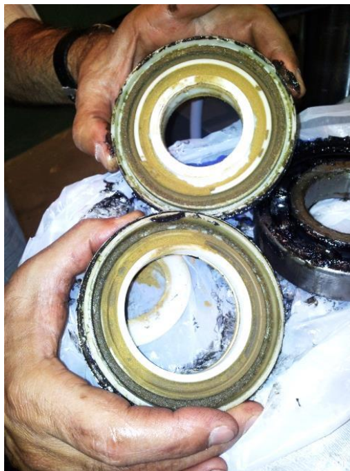
Слика 5.4: Канали лабиринтског заптивача попуњени нечистоћама
