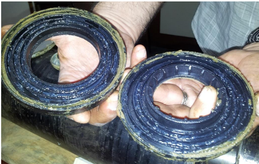
Слика 5.8: Нечистоће се налазе само у периферним жлебовима заптивача
