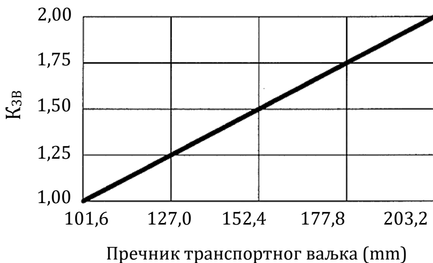
Слика 2.26: Фактор утицаја спољашњег пречника на радни век транспортног ваљка – K_{3B} [28]
