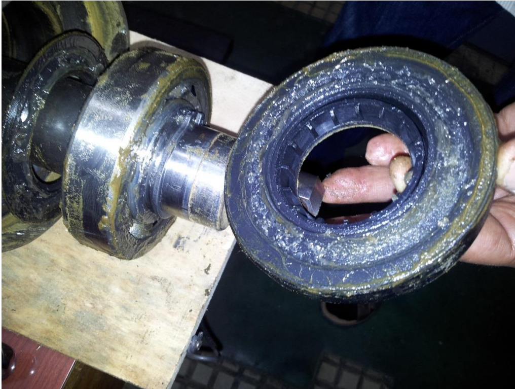
Слика 5.7: Нечистоће нису проиле до контактне површине заптивача и лежаја
