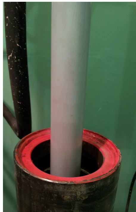
Слика 4.58: Монтажа алата за избијање котрљајног лежаја из цеви транспортног ваљка
