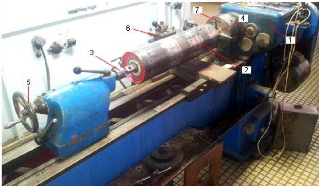
Слика 4.18: Универзални струг са монтираним транспортним ваљком и мерним инструментом (дигиталним компаратером)
