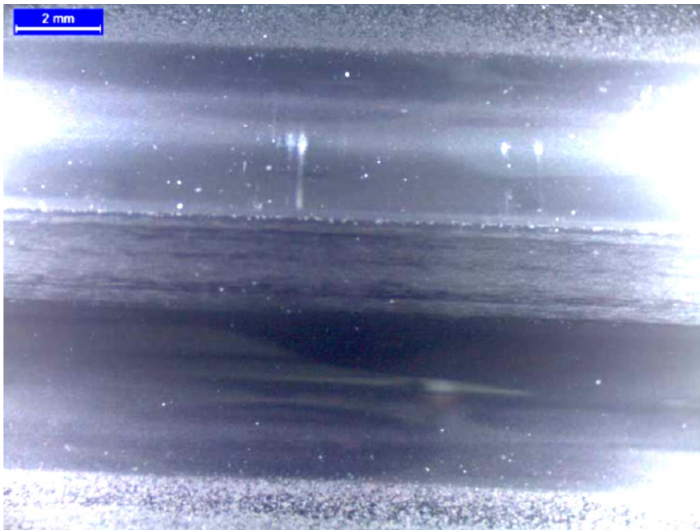
Слика 3.36: Репрезентативни микроскопски снимци површине стазе котрљања унутрашњег прстена, приказани у раду [53]
