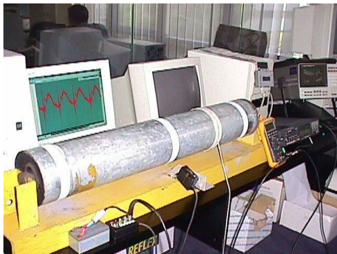
Слика 3.8: Испитивање радијалног бацања и профила површине транспортног ваљка изведено у Richard Heggie Associates Laboratory at Lane Cove, Australia [42]
