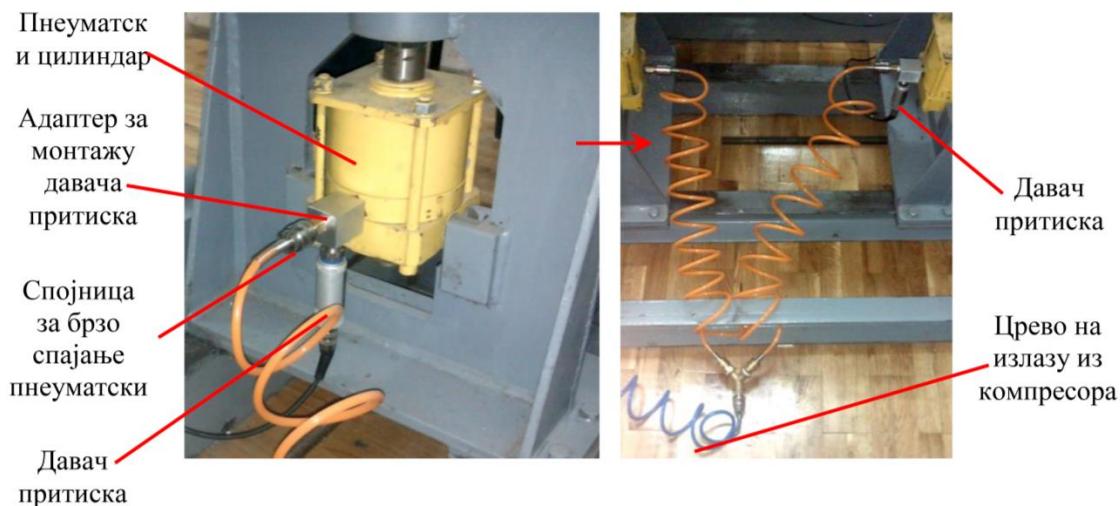
Слика 4.12: Давач притиска на пнеуматском цилиндру пробног стола
