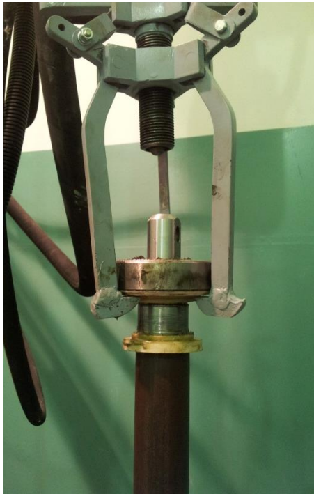
Слика 4.56: Притезање кракова свлакача око котрљајног лежаја на осовини транспортног ваљка
