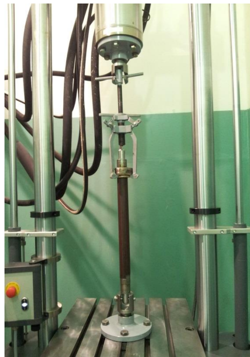
Слика 4.55: Спуштање клипа машине (са монтираним свлакачем), до позиције када се краци свлакача налазе испод котрљајног лежаја
