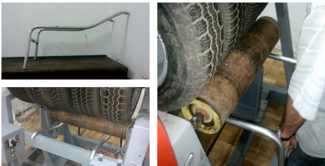
Слика 4.10: Алат за постављање транспортних ваљака на пробни сто
