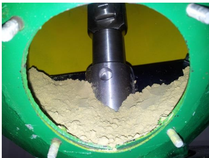
Слика 4.24: Контаминирајуће честице у комори пробног стола
