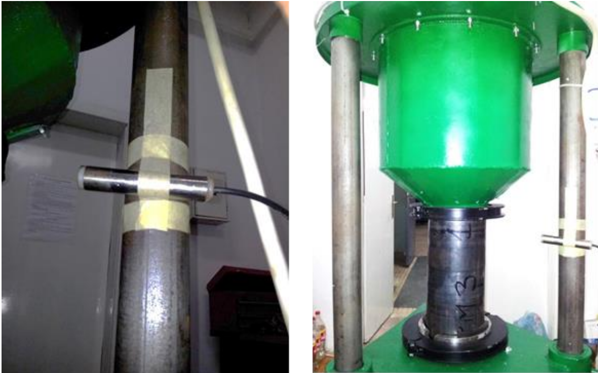
Слика 4.25: Давач нивоа буке монтиран на пробни сто за испитивање заптивних група транспортних ваљака
