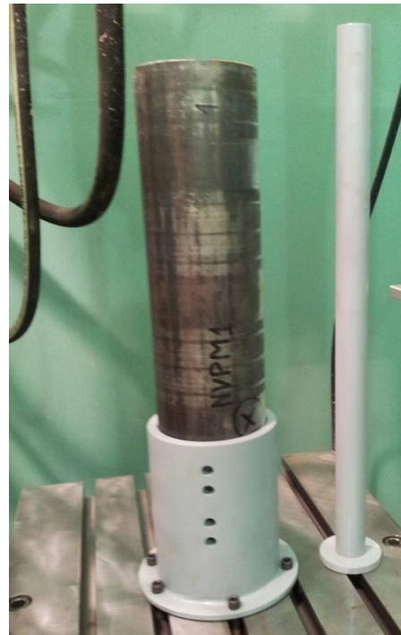
Слика 4.57: Монтажа цеви транспортног ваљка (са котрљајним лежајем) у алат за прихват
