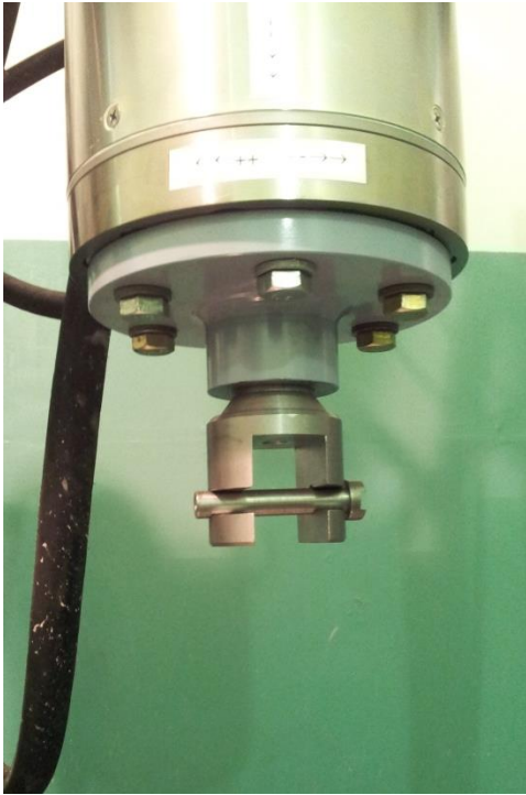
Слика 4.52: Монтажа алата за прихват свлакача (раданцигера)
