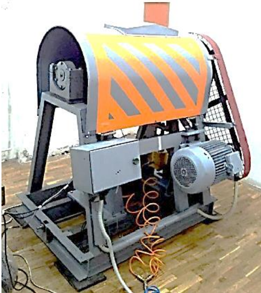
Слика 4.6: Прототип пробног стола за испитивање радног века и динамичке издржљивости транспортних ваљака
