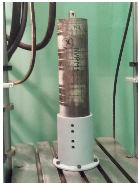
Слика 4.48: Монтажа испитиваног транспортног ваљка у алат за прихват
