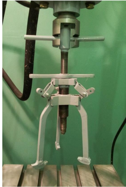
Слика 4.53: Монтажа свлакача (раданцигера)
