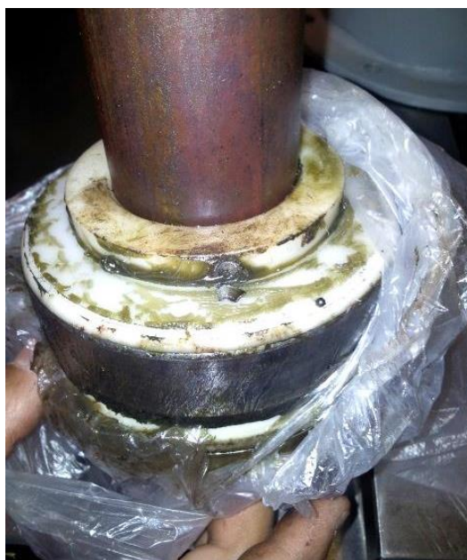
Слика 5.2: Елементи лежаја и заптивача извађени из испитиваног ваљка
