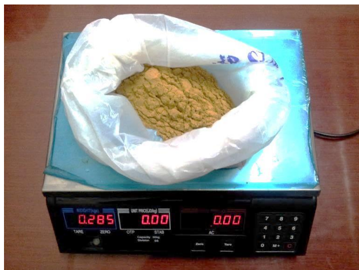
Слика 4.23: Мерење масе припремљених контаминирајућих честица на електронској ваги
