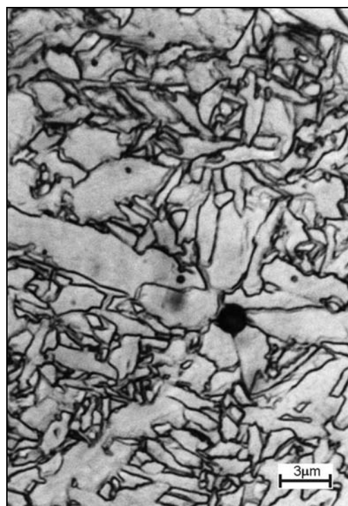
Slika 3. Nukleacija acikularnog ferita na uključcima tipa \text{MnOAl}_2\text{O}_3 ili \text{MnS} površinska prevlaka, /13/
