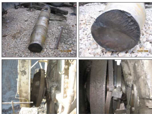
Slika 2.6. Lom osovine rotora i havarija male membrane
