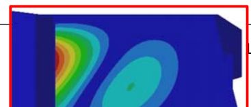
Слика 7.27. Други мод избочавања реконструисане структуре ( f_2 = 2,79 ) – LC7
