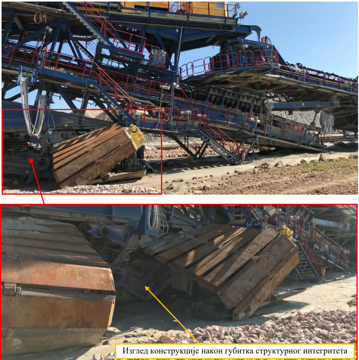
Слика 2.1. Лом фиксног гусеничног носача потпорне гусенице
