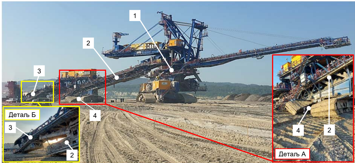
Слика 1. Одлагач РА 200 - 2200/2000 (РБ „Колубара“, ПК „Поље Ц“) након хаварије: 1-основна машина; 2-међутранспортер; 3-пријемни транспортер; 4-ослона гусеница међутранспортера.
