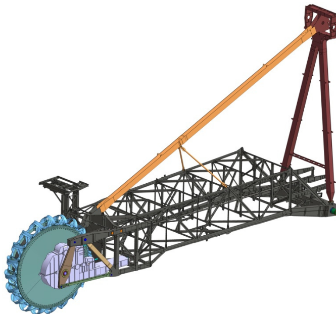
Слика 5.11. Подструктура 1 (ПС1): стрела ротора
