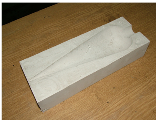
Slika A1.2. Izgled gipsanog kalupa za livenje poliesterske smole
