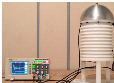
Slika 7.8. Fotografija sistema za snimanje odziva razdelnika na pravougaoni impuls
