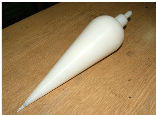
Slika A1.1. Izgled kalupa od sipasa za formiranje kalupa od gipsa
