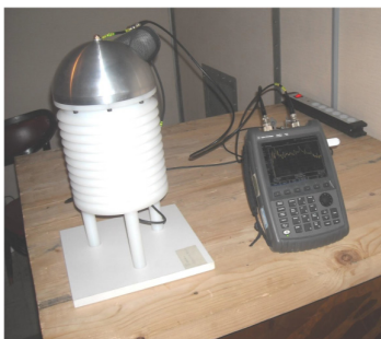
Slika 7.7. Fotografija sistema za snimanje prenosnih karakteristika razdelnika
