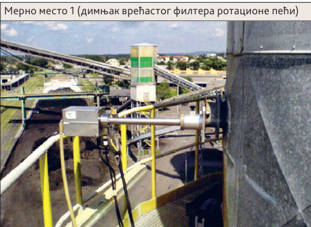
Слика 1 и 2. Мерна места са опремом за узорковање
