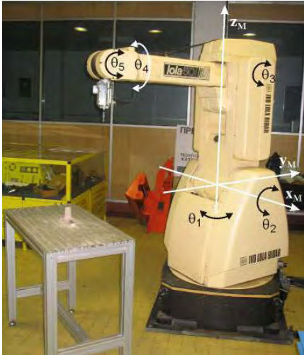
Slika 2. Eksperimentalni Laboratorijski 5-osni obradni sistem na bazi robota
