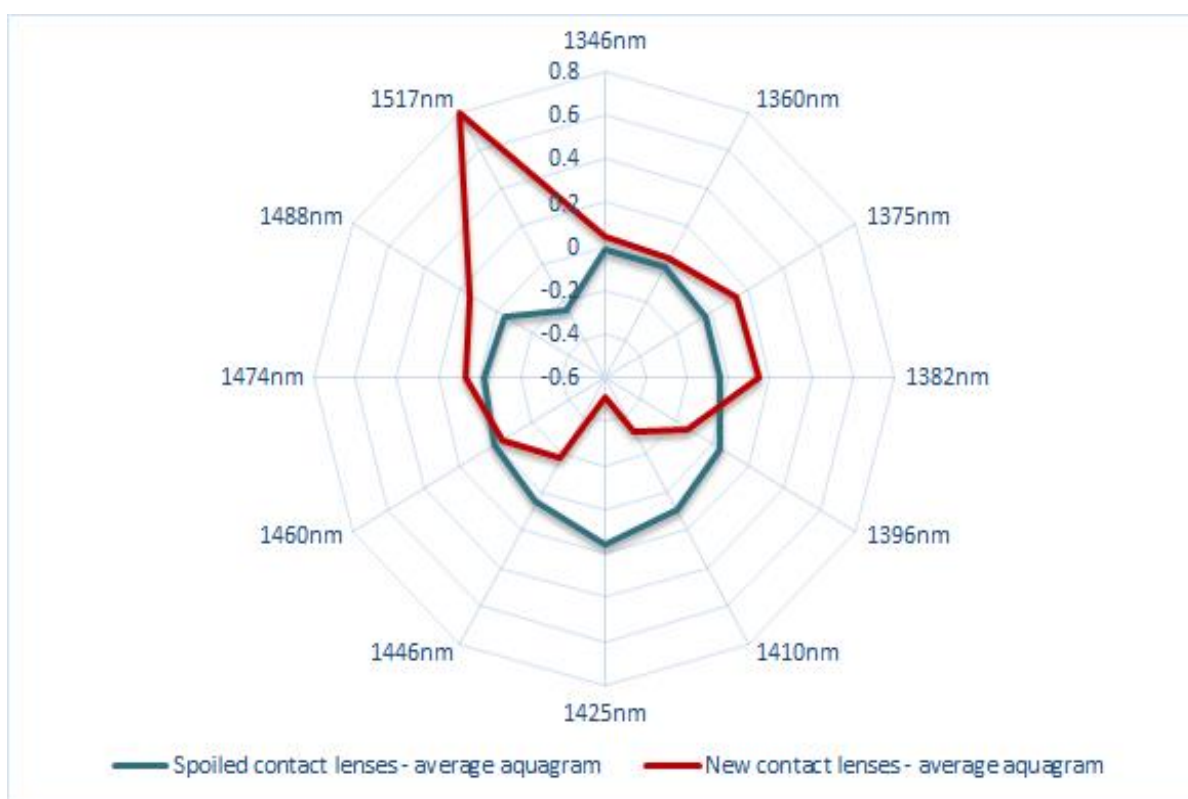
Slika 63. Osrednjeni akvagrami po klasama nošenih i nenošenih kontaktnih sočiva
