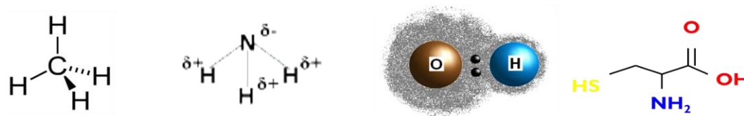
Slika 17. Najizraženije apsorpcione trake u bliskoj infracrvenoj oblasti potiču od overtona i kombinacije fundamentalne vibracije –CH, -NH, -SH i -OH funkcionalnih grupa
