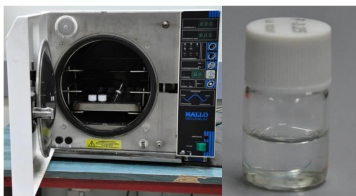
Slika 15. Parna sterilizacija mekih kontaktnih sočiva u autoklavu (Optix, Zemun).
