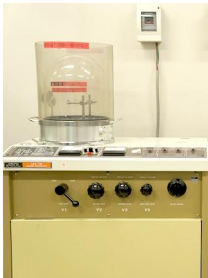
Slika 11. Uređaj za napanje tankih filmova u vakuumu iz gasne faze (Vacuum Evaporator JEE-400 (JEOL, Japan) (NanoLab 1, Mašinski fakultet, Univerziteta u Beogradu)
