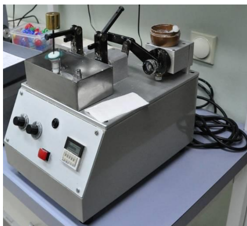
Slika 13. Poliranje frontalne površine obradka (Optix, Zemun).
