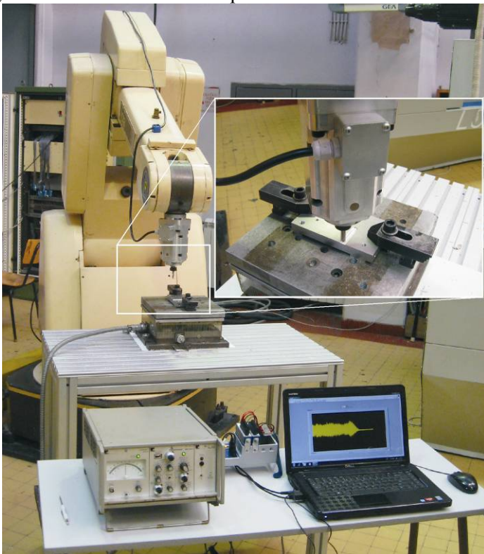
Slika 3. Eksperiment izrade žljeba glodanjem
