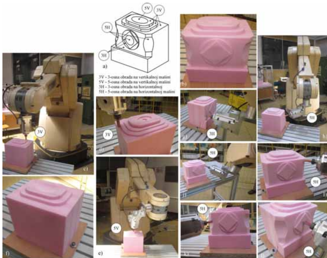
Slika 8. Obrada test dela koji zahteva višestranu obradu
