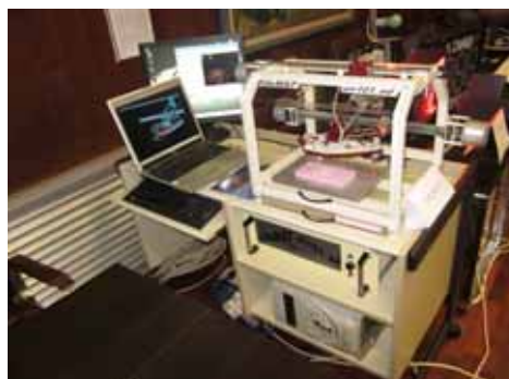
Slika 7. EduMAT sistem i troosna mašina sa paralelnom kinematikom na Sajmu najboljih tehnoloških inovacija 2011. godine
