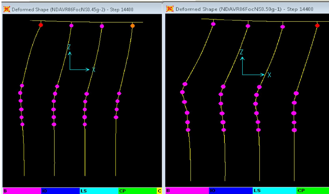
Слика 5.5.1.2.15. Стање пластичних зглобова, на крају Првог удара земљотреса 70sec. VR86FocsNS. NDA. Тло p -у криве за песак модификоване p -ум. а) PGA 0,45 g овде се у врховима стубова појављују следећи зглобови: 2 Y+1D+1E, б) PGA 0,50 g овде се у врховима стубова појављују следећи зглобови: 3Y+1E, што је боље стање него за PGA 0,45 g.
