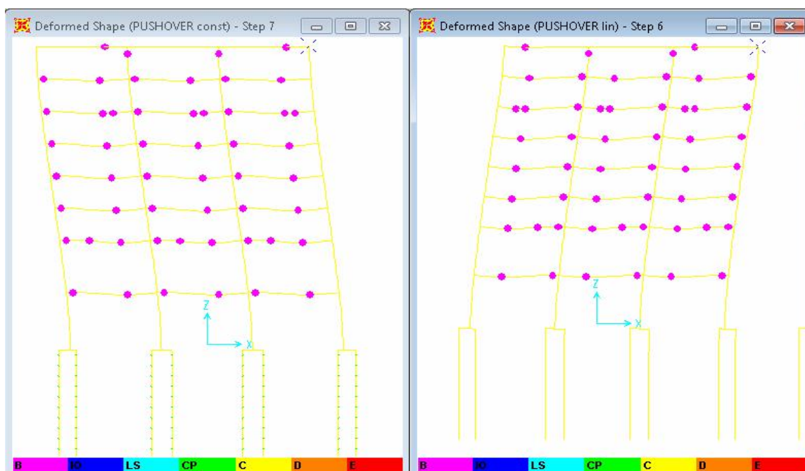
Слика 4.40 ПушOVER анализа 2Д фасадног рама. Стање пластичних зглобова. тлом као p -у криве, са коригованим линеарним делом крутости према коефицијентима хоризонталне интеракције. Лево оптерећење константно по спратовима, а десно линеарно променљиво.
