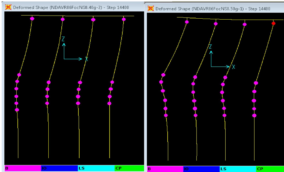
Слика 5.5.1.2.13. Стање пластичних зглобова, на крају Првог удара земљотреса 70sec. VR86FocNS. NDA. Тло p -у криве за песак модификоване. а) PGA 0,40g, б) PGA 0,50g овде се појављује и 1 зглоб различит од течења Y а то је стање E зглоба у врху крајњег десног стуба (овај зглоб више нема никакву резерву носивости)
