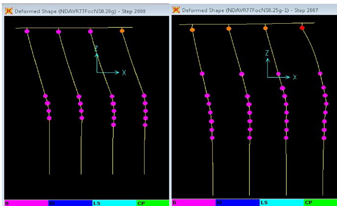
Слика 5.5.1.3.1. Стање пластичних зглобова, на крају Првог удара земљотреса 40sec. VR77FocsNS. NDA. Тло p -у криве за песак модификоване. а) PGA 0,20g овде се у врховима стубова појављују следећи зглобови: 3Y+1D, б) PGA 0,25g овде се у врховима стубова појављују следећи зглобови: 3D +1C, практично је конструкција срушена иако су доњи делови стубова и шипови и даље способни да пренесу оптерећење, за даљу анализу неопходно је погледати и померање чворова и дрифт.
