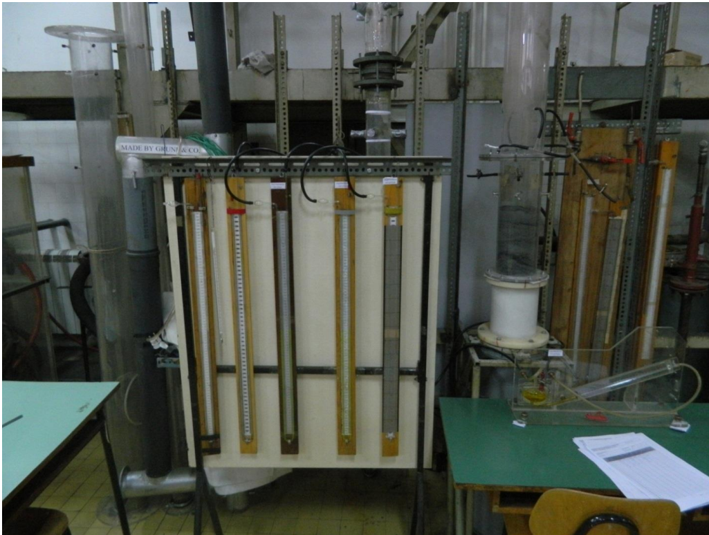
Slika 2. Aparatura za ispitivanje fluidizacije i određivanje koeficijenta permeabilnosti sa nasutim uzorkom
