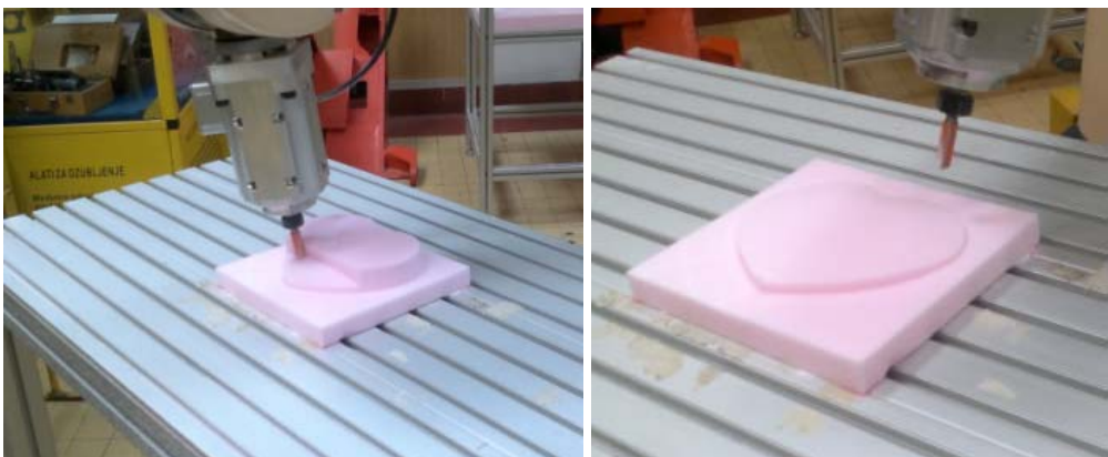
SI.6 Primer obrađenog dela višeosnom obradom
