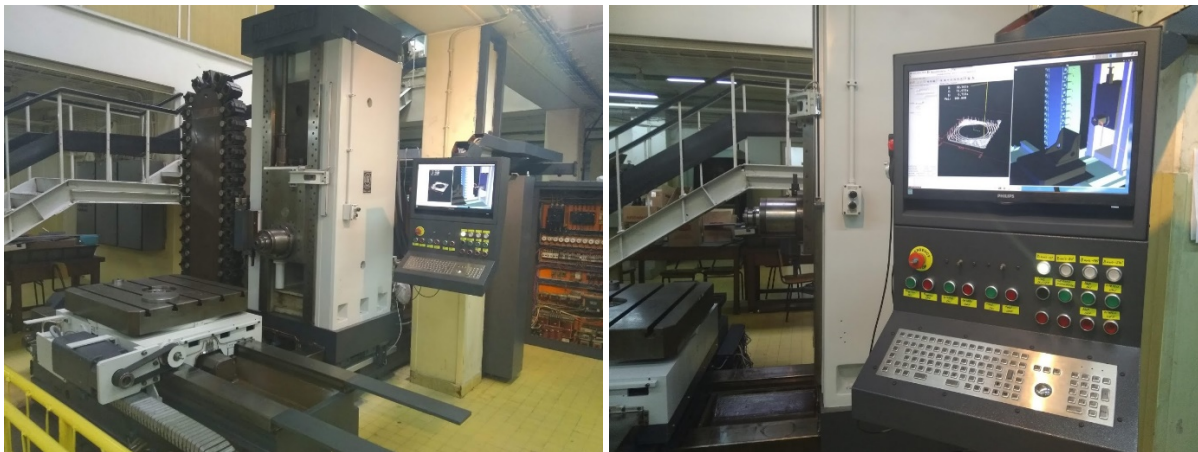
Slika 11. Mašina posle revitalizacije, LOLA HBG V3, sa LinuxCNC upravljanjem
