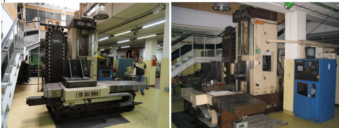
Slika 1. Originalna mašina LOLA HBG 80 sa Bosch Micro 5 upravljanjem
