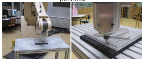
Slika 5.3 Obrada konture kvadrata test radnog dela na robotu LOLA50
