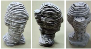
Slika 3.4 Model dobijen lepljenjem slojeva kartona
